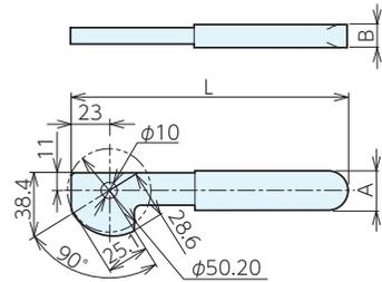
CAM LEVERS FOR CENTER CLAMPING &lt;TYPE A&gt;
