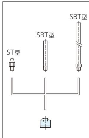
喷嘴前端采用螺纹式，可安装喷头或导管。
